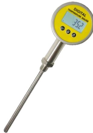
El termómetro remoto digital STD, es un termómetro con pantalla digital LCD incorporada, con gran precisión y estabilidad a largo plazo, mostrando la temperatura en tiempo real y transmitiendo una señal remota para realizar control de procesos. Posee varias funciones como cambio de unidad para °C y °F, corrección de escala completa y filtrado digital, es simple de operar y fácil de instalar.
