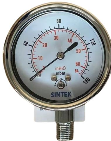
Manómetro análogo SINTEK, instrumento utilizado para la indicación y medición de la presión en los diferentes tipos de procesos, con funcionamiento por medio de tubo de Bourdon el cual mueve la aguja cuando se genera presión en la entrada del manómetro, con diferentes rangos de escalas según el proceso requerido con medios de medición como aire, agua, amoniaco, aceite, gas, entre otros.
