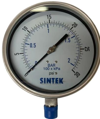
Manómetro análogo SINTEK, instrumento utilizado para la indicación y medición de la presión en los diferentes tipos de procesos, con funcionamiento por medio de tubo de Bourdon el cual mueve la aguja cuando se genera presión en la entrada del manómetro, con diferentes rangos de escalas según el proceso requerido para medición de aire, agua, aceite, gas, entre otros.
